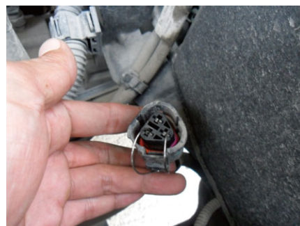
图3 短接水温开关高速挡
