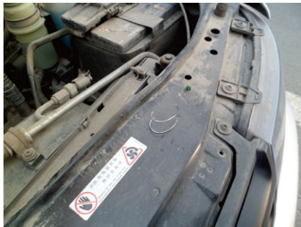
图2 自制钥匙环跨接工具
