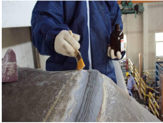
氢气管道弯头焊缝渗漏（UPVC）
