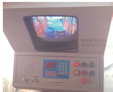
自动停层、语音及影像信号监控装置
