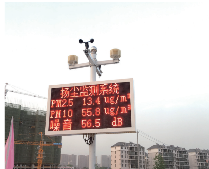
PM2.5 粉尘监测设备和智慧喷淋系统
