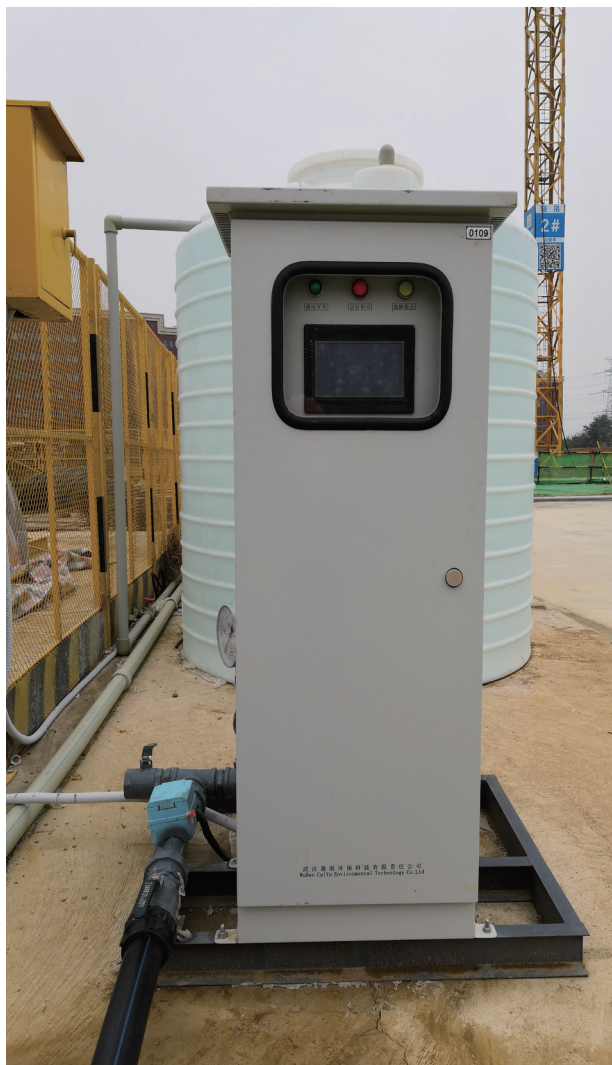
PM2.5 粉尘监测设备和智慧喷淋系统
