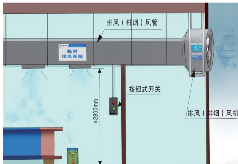
加工车间通风系统示意图
