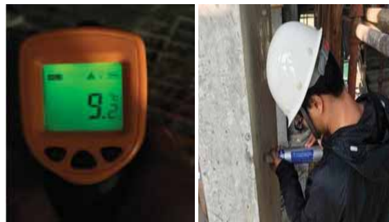
混凝土测温, 对受冻临界点强度进行检测
