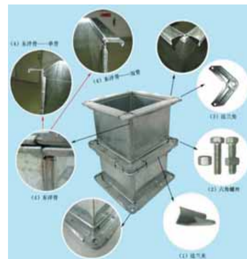
共板法兰风管各细部配件实例图
